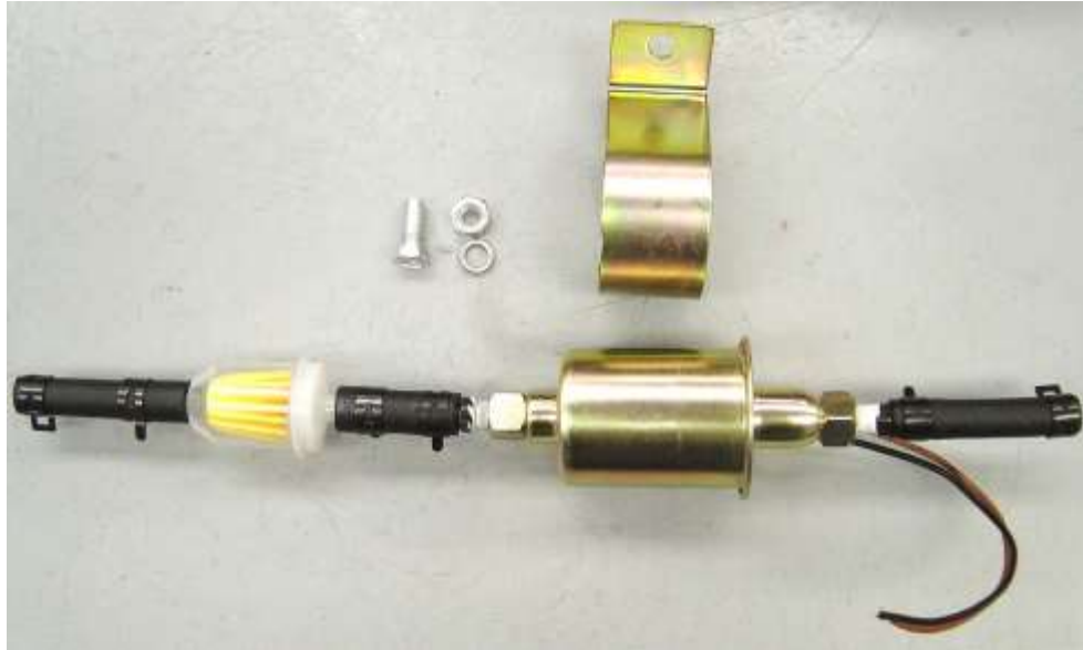
Figura 3. Vista en que se observa la orientación de las mangueras y abrazaderas.
